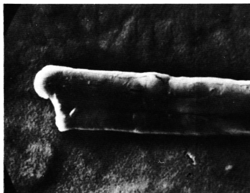
Fig. 9 — Fragmento de fibra vegetal, com parede dupla, lúmen central e dobra transversal, de aproximadamente 10 \mu\text{m} , em amostra do grupo B. Notar a presença de fraturas e irregularidades de superfície (microscopia eletrônica de varredura - 800x).
