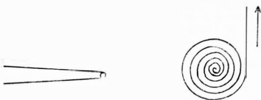
Fig. 7 — Tipos de mola: (a): alavanca; (b): roldana com eixo, ou sarilho (exemplo: trenas de medições métricas).
